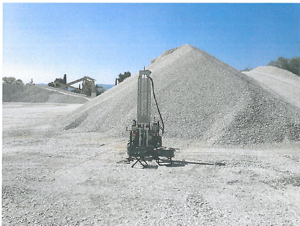
Figura 4- Esecuzione prova penetrometrica dinamica P3.
