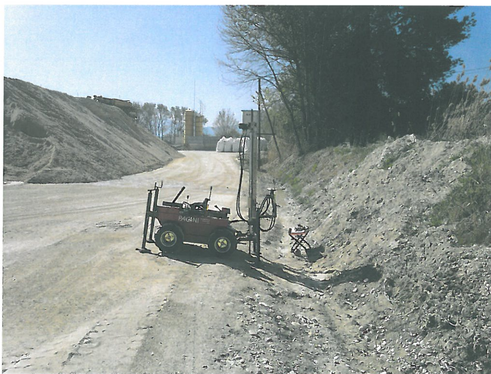
Figura 1- Esecuzione prova penetrometrica dinamica P1.
