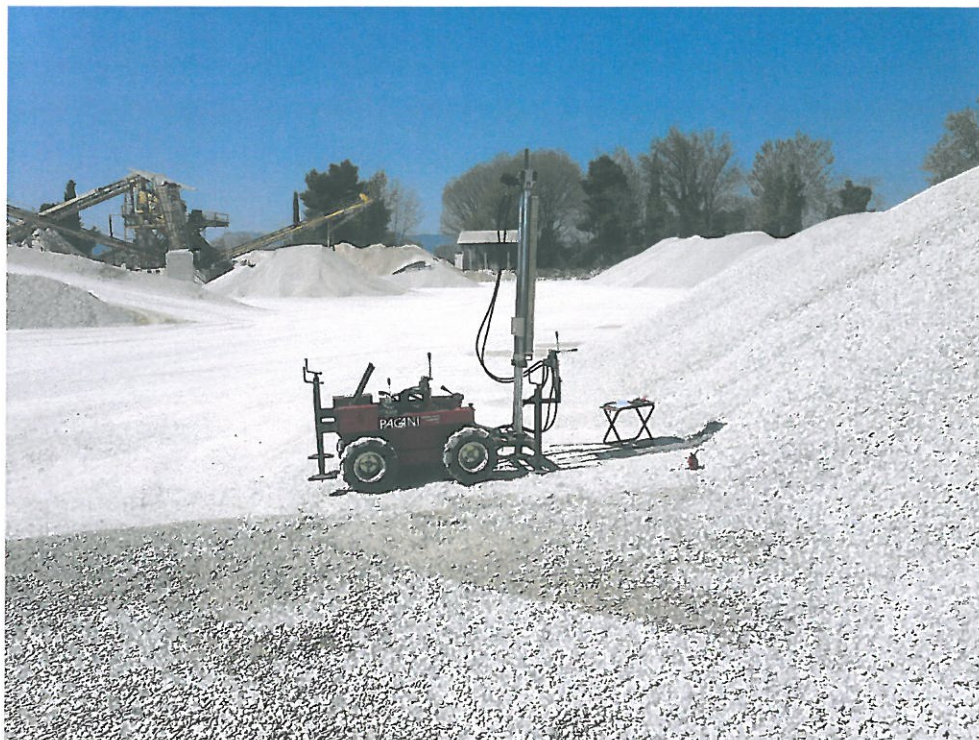
Figura 2- Esecuzione prova penetrometrica dinamica P2.
